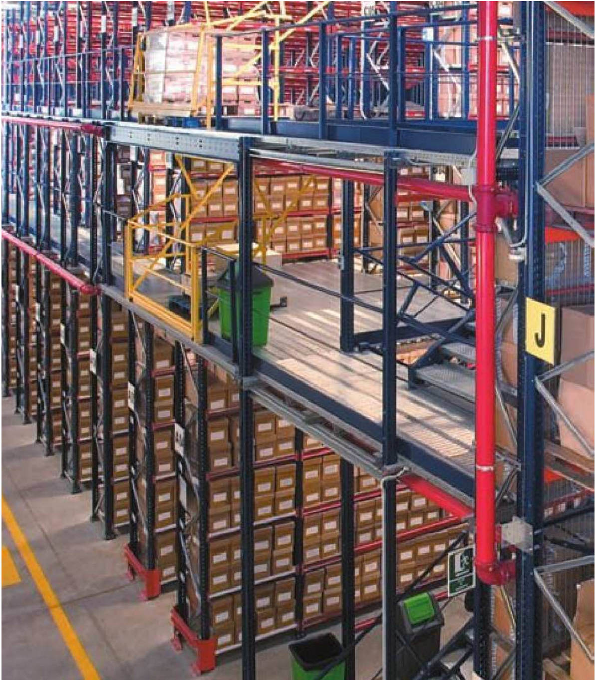
Pickingregale mit Laufgang
