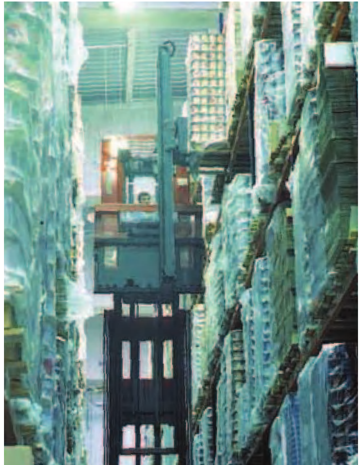
Schmalgangstapler bei der Lagerung/Entnahme.
