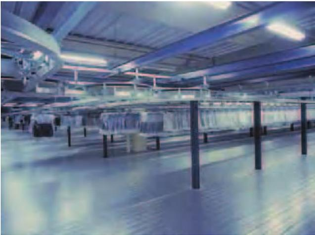
Die Bühnenkonstruktion, in diesem Fall mit mehreren Ebenen, wird zur Klassifizierung und Lagerung hängender Kleidungsstücke genutzt. Die Struktur selbst trägt außerdem die Rollenelemente für die Schlitten mit den Kleidungsstücken.
