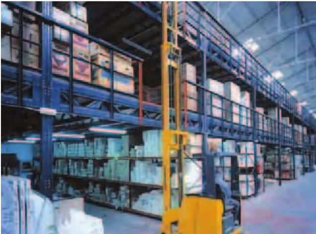
Diese Anlage besteht aus zwei Zwischenebenen. Auf der unteren Etage wurden Regale für mittelgroße und kleinere Waren mit häufigeren Kommissioniervorgängen aufgestellt. Die obere Etage wird zur Lagerung großvolumiger oder Produkte mit geringem Umschlag genutzt.
